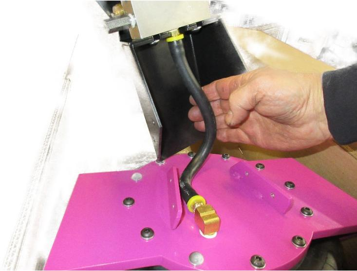
**STEP 2: PULL AIR HOSE TOWARD YOU WHILE POSITIONING BOLT HOLES ON BLACK HANDLE GUARD**
